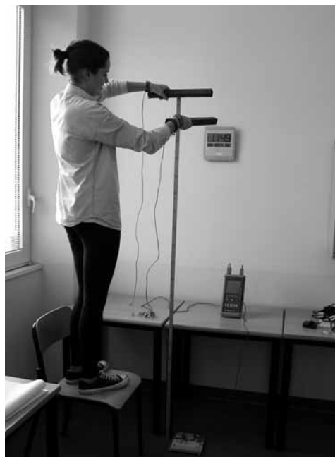
Figura 3. Foto dell'apparato sperimentale con, in basso, il microfono, il circuito di trigger, l'oscilloscopio e i tubi.
