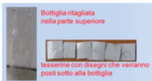
Figura 6. I bambini misurano la trasparenza dell'acqua in modo indiretto: misurano il livello dell'acqua che, posta in una stessa bottiglia appoggiata su un disegno, non permette più di vedere il disegno.
