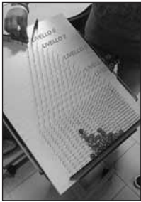
Figura 4. Indicazione dei livelli dai quali sono state farre partire le biglie. Il livello più distante è stato numerato come livello 0.
